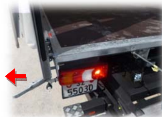
Heckpfosten seitlich ausfahrbar
