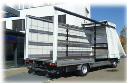
Schiebeverdeck einfach nach vorne oder nach hinten verschiebbar
