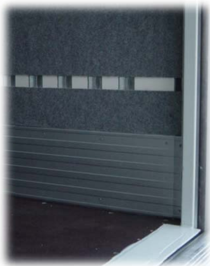
Innenausbau mit Nadelfilz für Möbeltransport
