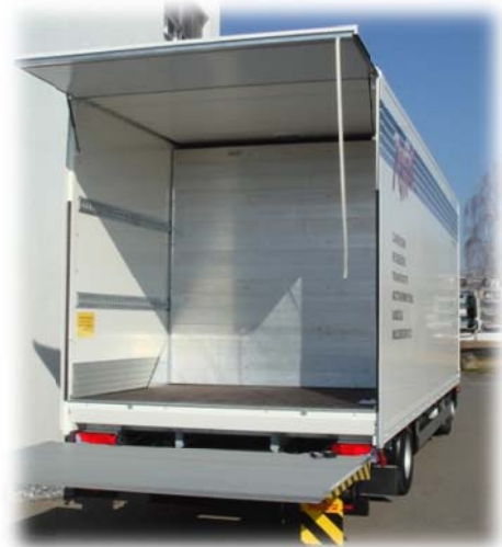
Innenausbau mit verschiebbarer Stirnwand
